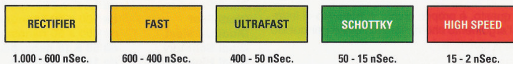
Fig.1 I diodi meno veloci sono quelli che hanno una velocità compresa tra 1.000-600 nanosecondi e vengono utilizzati per raddrizzare la tensione di rete dei 50 Hertz, mentre i più veloci sono gli High Speed che possono raggiungere i 12-2 nanosecondi.
